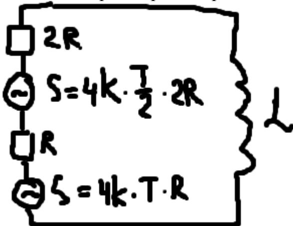
Складывать резисторы – это просто, будет  $3R$ . А как сложить два источника случайного напряжения? От одного  $4kTR$ , от другого  $4kTR$  – их можно заменить одним источником случайного напряжения с  $S = 8kTR$ . Почему? Потому что шумы гауссовы, и дисперсия от двух источников равна сумме дисперсий.
