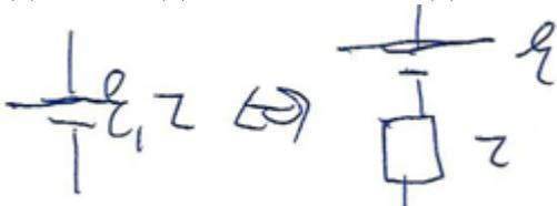
Так и нагретый резистор можно представить в виде последовательно включённых обычного резистора и источника случайного напряжения, чьей характеристикой будет не ЭДС, как мы привыкли, а  $S = 4kTR = 4\theta R$ .
