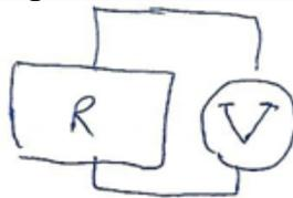
его концам очень точный вольтметр, то его показания будут чуть-чуть колебаться - а на сколько (в среднем)? Ответ мы скоро узнаем.
