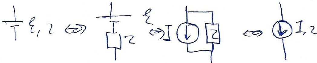
Когда источник напряжения, соединение последовательное
