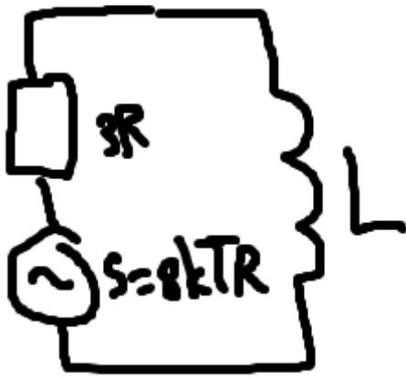
$$S_L(\omega) = |K(\omega)| \cdot 8kTR = \frac{(\omega L)^2}{R^2 + (\omega L)^2} \cdot 8kTR$$
