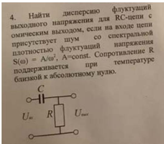
Формула  $\tilde{S}_{\text{ВЫХ}}(\omega) = |K(\omega)|^2 \tilde{S}_{\text{ВХ}}(\omega)$  остаётся верной для любых шумов. Комплексный коэф передачи будет  $R/(1-i/(\omega C))$ , модуль его квадрата –  $R^2/(1+1/(\omega C))^2$ . Домножаем на  $S_{\text{ВХ}}(\omega)$  (равное по условию  $A/\omega^2$ ) и получаем ответ  $A/\omega^2 * R^2/(1+1/(\omega C))^2$ .
