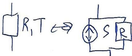
Только если хар-ка источника случайного напряжения – это спектральное разложение квадрата **напряжения**  $S=4kTR$ , то хар-ка источника случайного тока – это спектральное разложение квадрата **тока**  $S=4kT/R$ .
