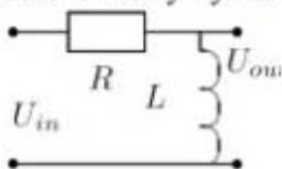
Считаем комплексный коэф передачи:  $K(\omega) = \frac{i\omega L}{R+i\omega L}$ .
