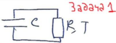
Вот в такой цепи с изначально незаряженным конденсатором тока бы не было, но из-за тепловых флуктуаций в резисторе конденсатор то заряжается, то разряжается. Что будет, если мы применим Фурье к квадрату напряжения (выходного) на конденсаторе?
