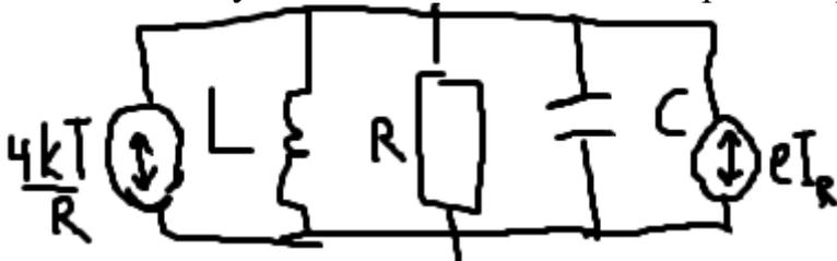
Ведь в этом случае у нас указывается два параллельно подключённых источника случайного тока. Мы просто приравниваем их спектральные плотности квадрата тока.
